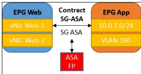
Figuur 5: EPG's met Contract gelinkt aan Service Graph met ASA with FirePOWER
